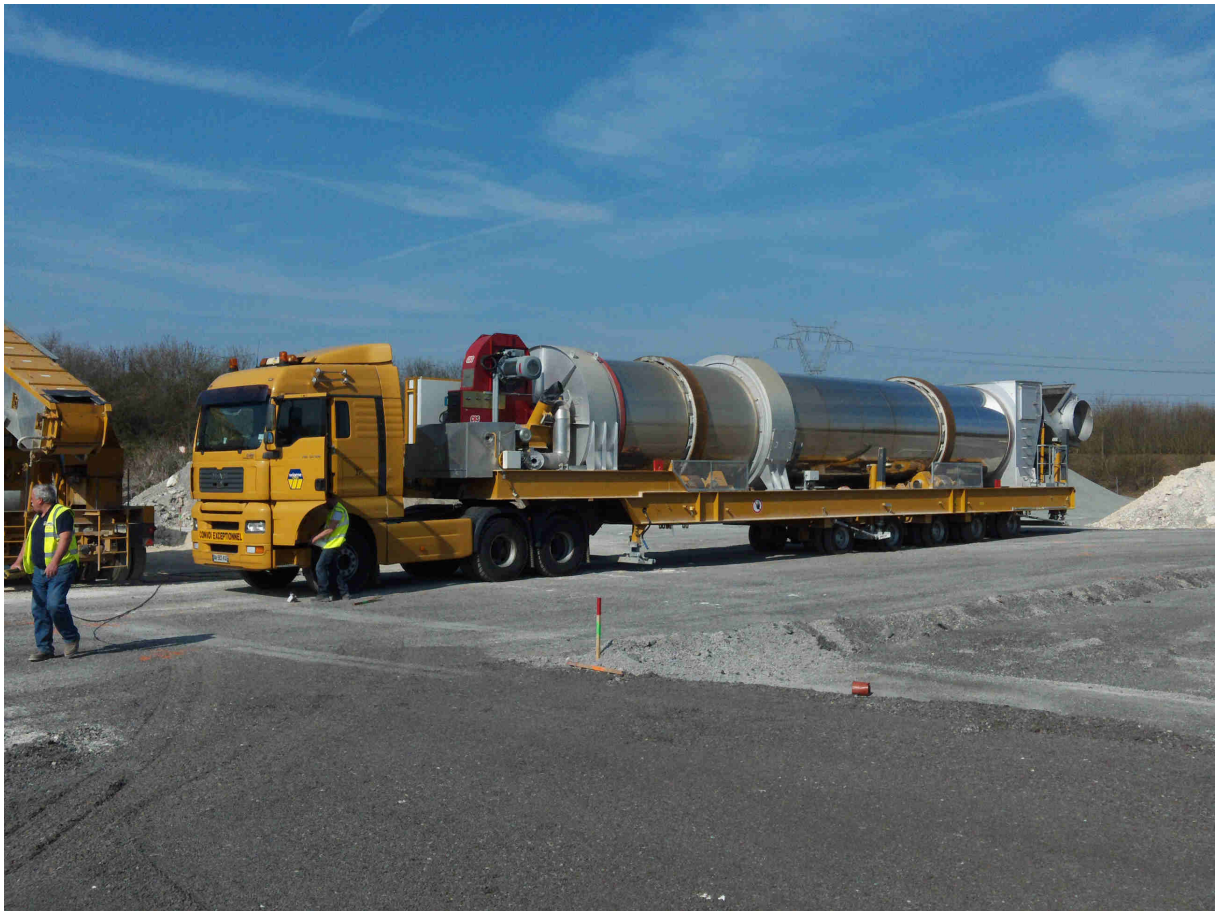
Transport du tambour de la centrale mobile RF 400
